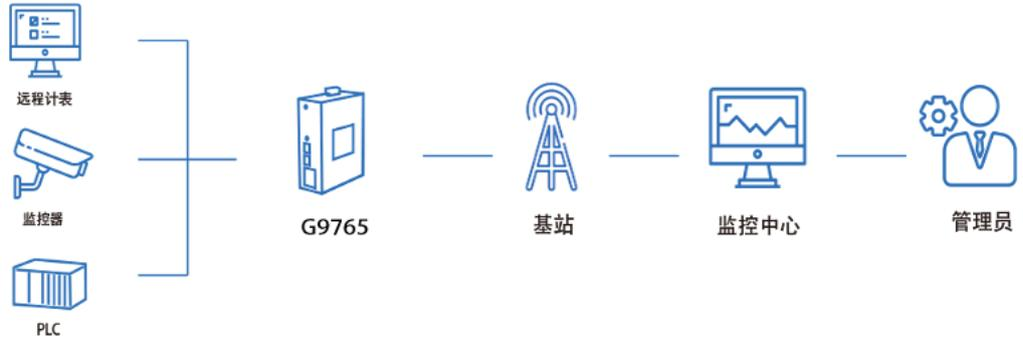
工业生产现场的PLC、HMI、高清摄像头等智能设备通过各种工业总线或高速以太网连接G9765网关，G9765进行数据采集、数据预处理、数据过滤、数据清洗。完成的之后通过MQTT、HTTP等物联网常用传输协议发送到云端系统。物联网云平台可以部署在企业私有数据中心或公共云服务平台。云平台可实现设备远程状态监控，实时告警通知和故障诊断分析，远程故障定位和程序升级，设备资产管理，设备预防性维护以及工业大数据挖掘等功能。协助生产制造商打造一整套工业智能远程运维管理系统解决方案。
