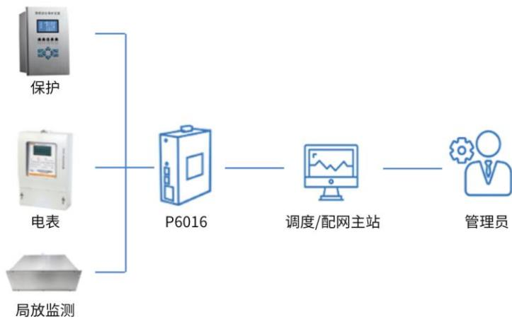
在电力现场，通讯管理机用于将一个变电所内所有的智能监控/保护装置的通讯数据整理汇总后，实时上送上级主站系统，完成遥信、遥测功能。另一方面接收主站系统下达的命令，并转发给变电所内的智能系列单元，完成对厂站内各开关设备的分、合闸远方控制或装置的参数整定，实现遥控和遥调功能。
