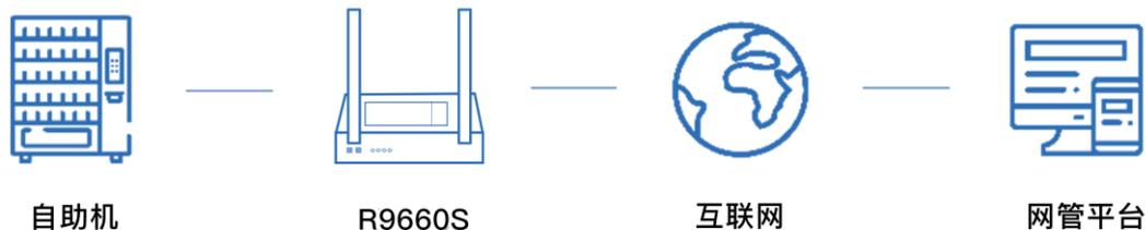
自助售货机、自助售票机等自助零售终端，大部分应用于商场以及地铁、火车站等位于负楼层的地点，联网布线难，成本过高。并往往会面临着网络信号差、运行不稳定等问题。R9660S系列工业路由器很好的解决了这些问题，使用无线联网替代有线联网，节省建设成本。构建4G联网保证网络状况，并与自助机联网系统的管理中心服务器主机建立数据通道，实现自助机终端无线组网，实时上传零售数据。支持多种VPN加密模式，为自助机提供数据传输安全防护。
