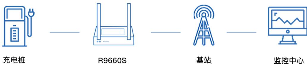
充电基础设施主要包括各类集中式充换电站和分散式充电桩。由于充电设施位置分散，数量庞大，为保证用户体验和运营效率，就必须要对这些充电设施进行联网并构建充电智能服务平台。针对不同的充电设施及客户需求，锐谷提供了差异化的解决方案。对于分散式充电桩，采用锐谷工业无线数据传输终端R9660S进行联网。对于集中式的充换电站，或者有些充电运营企业采用箱变等技术推出群智能充电系统，锐谷提供工业路由器R9660S实现充电设施的联网。
