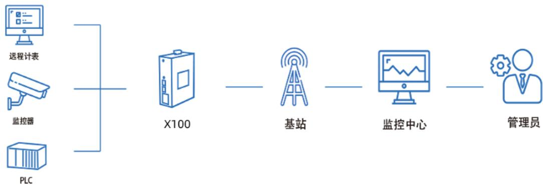
工业生产现场的PLC、HMI、高清摄像头等智能设备通过各种工业总线或高速以太网连接X100网关，X100进行数据采集、数据预处理、数据过滤、数据清洗。完成之后通过MQTT、HTTP等物联网常用传输协议发送到云端系统。物联网云平台可以部署在企业私有数据中心或公共云服务平台。云平台可实现设备远程状态监控，实时警报通知和故障诊断分析，远程故障定位和程序升级，设备资产管理，设备预防性维护以及工业大数据挖掘等功能。协助生产制造商打造一整套工业智能远程运维管理系统解决方案。
