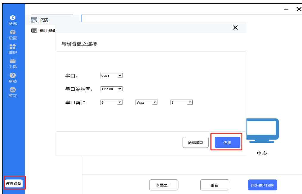
4.1.2 设置本地串口1参数，使设备的本地串口参数与连接的下位机设备串口参数一致。
