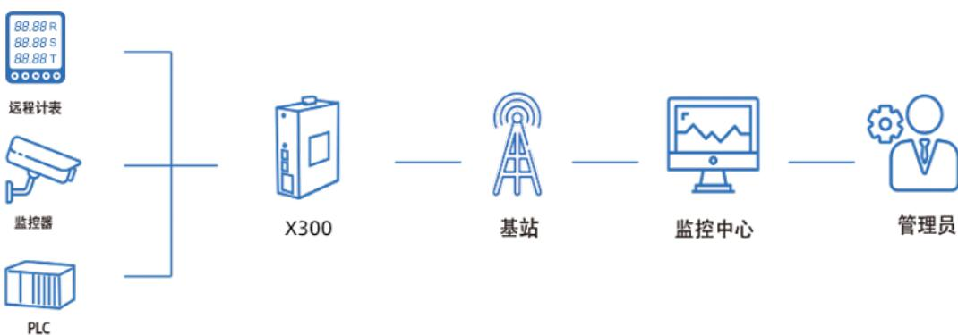
工业生产现场的PLC、HMI、高清摄像头等智能设备通过各种工业总线或高速以太网连接X300网关，X300进行数据采集、数据预处理、数据过滤、数据清洗。完成之后通过MQTT、HTTP等物联网常用传输协议发送到云端系统。物联网云平台可以部署在企业私有数据中心或公共云服务平台。云平台可实现设备远程状态监控，实时告警通知和故障诊断分析，远程故障定位和程序升级，设备资产管理，设备预防性维护以及工业大数据挖掘等功能。协助生产制造商打造一整套工业智能远程运维管理系统解决方案。
