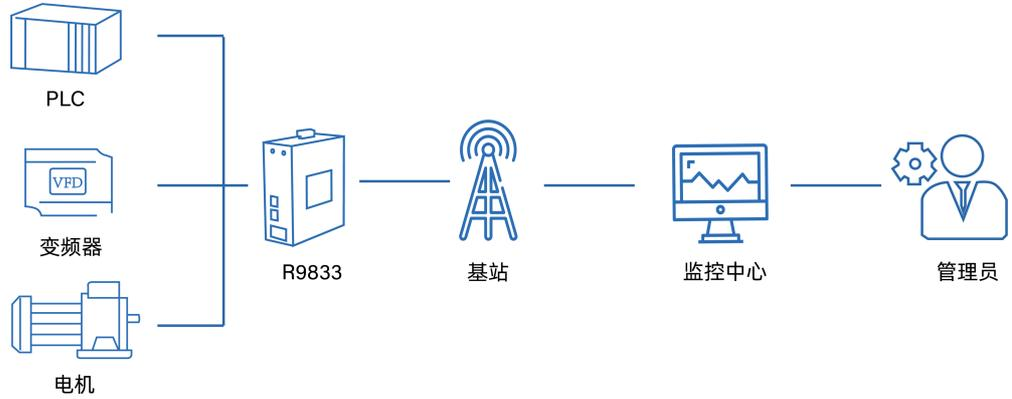
矿业开采生产现场的PLC、HMI、变频器等智能设备通过以太网或RS485连接R9833产品，并且可以通过蜂窝网络接入至锐谷提供的GoConnect工业远程维护云服务，为客户维护人员提供快速便捷安全的维护隧道，方便的访问现场自动化控制系统，对现场设备进行实时在线调试、变量跟踪、维护诊断、远程程序上下载、数据采集等操作。帮助智能装备客户的工程人员提供在线远程维护、数据采集等服务，更加高效快速的解决现场问题，提升现场设备生产效能。
