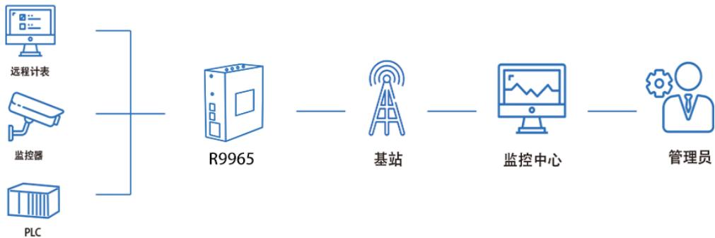
工业生产现场的PLC、HMI、高清摄像头等智能设备通过高速以太网连接R9965路由，R9965将工业数据通过5G网络，有线以太网或无线Wi-Fi等多种通信方式传输到云平台，实现设备远程状态监控，实时告警通知和故障诊断分析，远程故障定位和程序升级，设备资产管理，设备预防性维护以及工业大数据挖掘等功能。协助生产制造商打造一整套工业智能远程运维管理系统解决方案。
