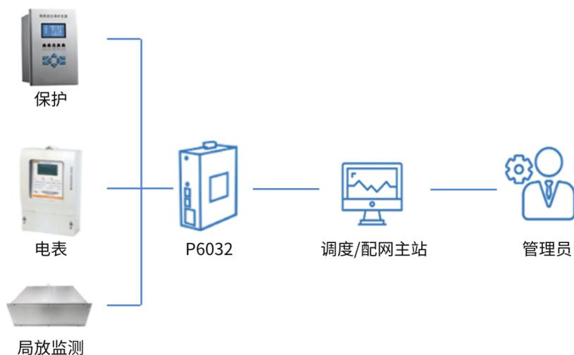
在电力现场，通讯管理机用于将一个变电所内所有的智能监控/保护装置的通讯数据整理汇总后，实时上送上级主站系统，完成遥信、遥测功能。另一方面接收主站系统下达的命令，并转发给变电所内的智能系列单元，完成对厂站内各开关设备的分、合闸远方控制或装置的参数整定，实现遥控和遥调功能。
